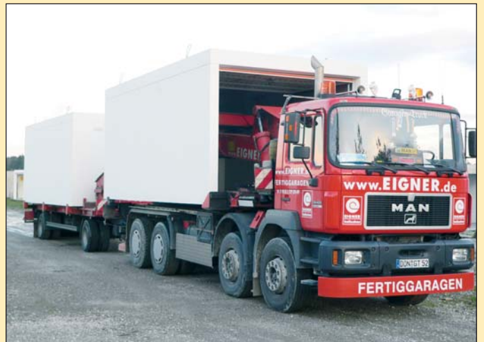
Transport von Betonfertiggaragen mit Garagenversetzfahrzeug
